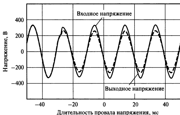
Рис. 13.23. Реакция устройства ДКИН на остаточное напряжение, равное 80 % номинального
