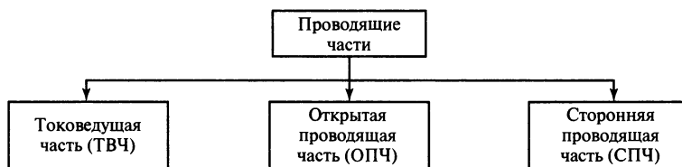
Рис. 23.2. Классификация проводящих частей
